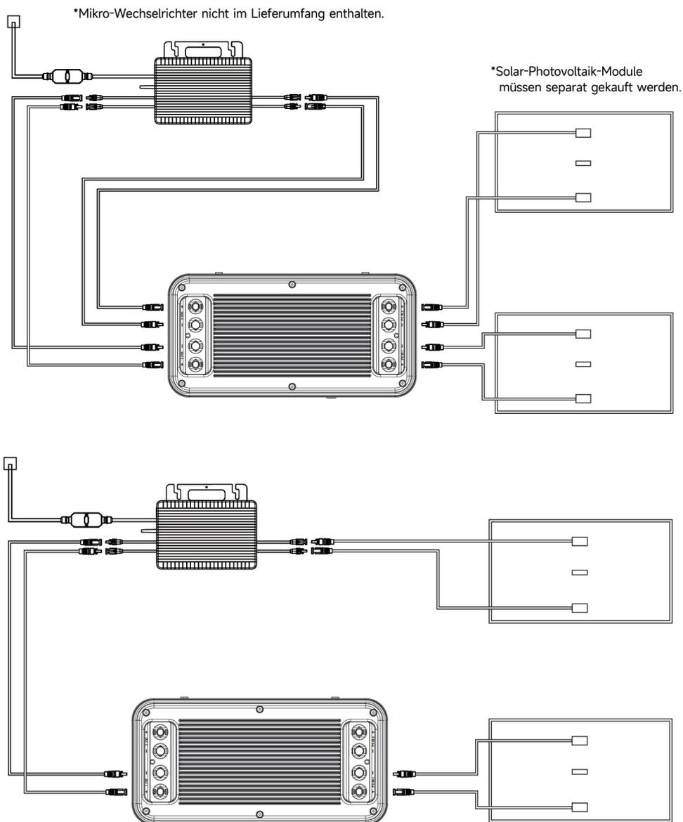
Wenn Sie feststellen, dass der Mikro-Inverter nach der oben beschriebenen Verbindung nicht ordnungsgemäss funktioniert, verbinden Sie bitte auf folgende Weise: Verbinden Sie einen der Mikro-Inverse mit dem Output1 des Produkts, und der andere Mikro-Inverse wird entweder ausgesetzt oder mit der Solarenergie verbunden.
